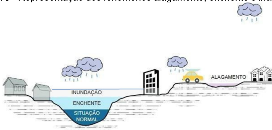
Figura 3 - Representação dos fenômenos alagamento, enchente e inundação
